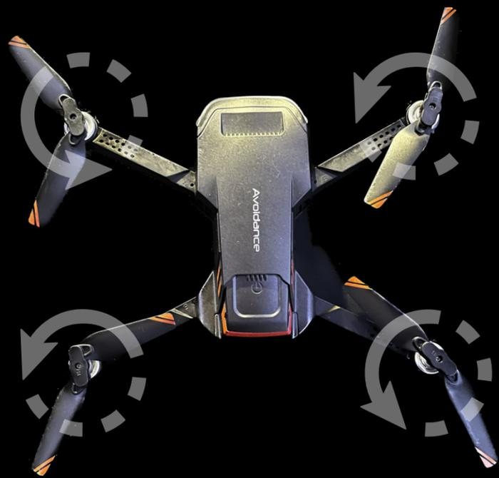
Las hélices tienen que tener el paso opuesto dos a dos para que rotando en direcciones opuestas lancen el aire en la misma dirección.
